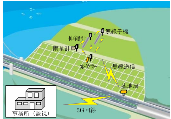
図-1.無線センサを活用した斜面監視システム
