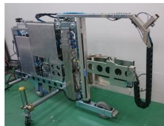
写真-1 狭隘部移動装置
