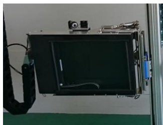
写真-3 ひび割れ調査機
