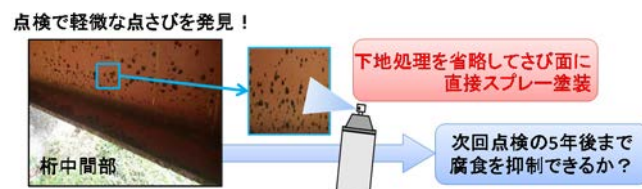
図-2 点検時の応急塗装のイメージ
