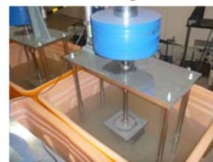
図 3 長期曲げ強度測定状況
