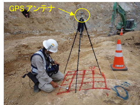
写真-2 打球探査法の実施状況
