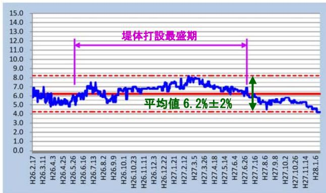
図-3 細骨材の表面水率の推移
