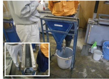
写真-2 V漏斗試験状況
