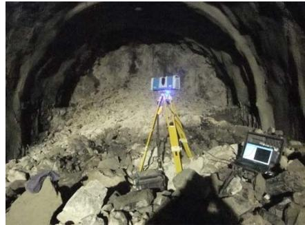
写真-4 3Dレーザスキャナを用いた断面測定状況
