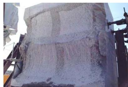
写真-3 掘削後の模擬岩盤
