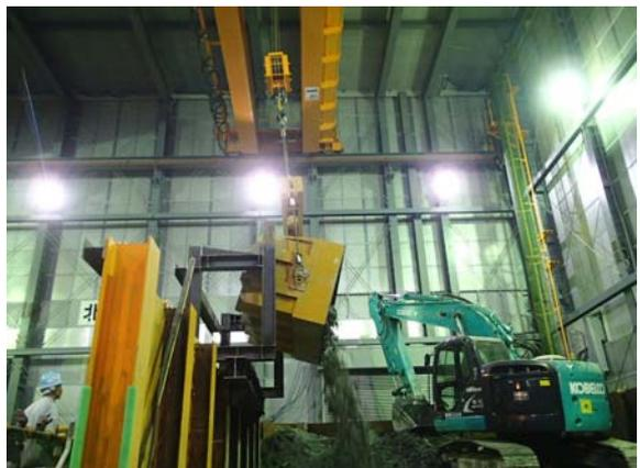
写真-5 自動ベッセル転倒器
