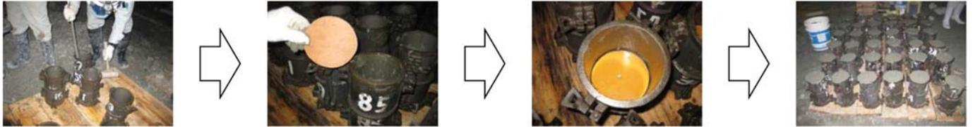
写真-3 円柱供試体作成状況(付着強度試験用)
