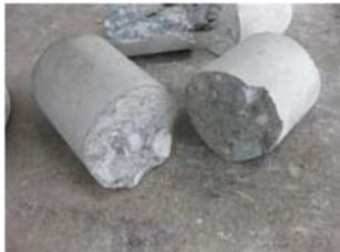
写真-5 打継ぎ面の付着状況(付着強度試験供試体)
