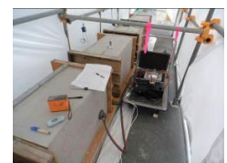
写真-3 試験状況（左: SWAT, 右: 透気試験）
