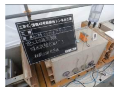
写真-3 試験状況（左: SWAT, 右: 透気試験）
