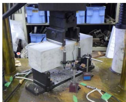
写真-1 曲げ靱性試験状況
