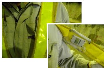
写真-1 アクティブ RFID タグ
