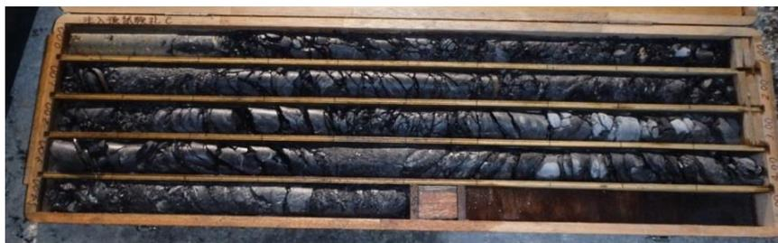
図-4 KOD-M 注入後 C 孔のボーリングコア
