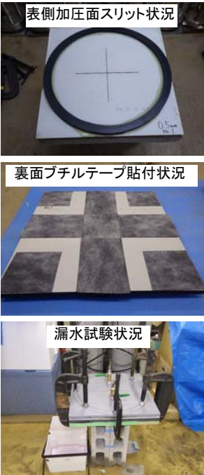
図-3 継目漏水試験
