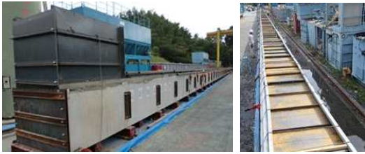
写真－2 2層目打設時の実験模型
