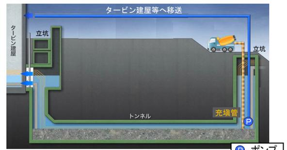
図-2 海水配管トレンチの施工イメージ
