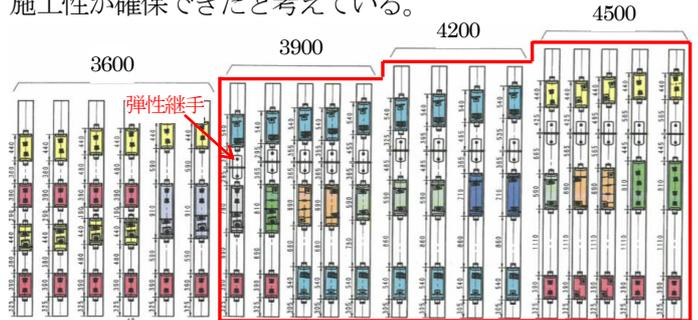
図4 分岐床板および弾性継手の設置図
