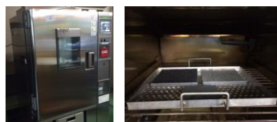
図1 恒温恒湿器による熱劣化試験状況 (試験体寸法 100mm×100mm)
