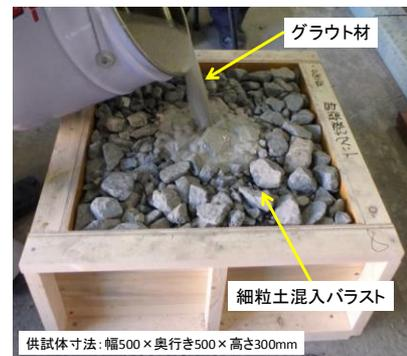
図2 試験供試体の概要
