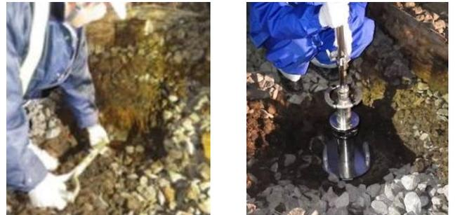
図-3 土質試料採取(左)、小型 FWD 試験(右)
