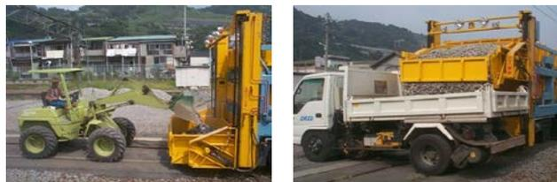
図-4 新砕石・発生砕石の積込、取卸し
