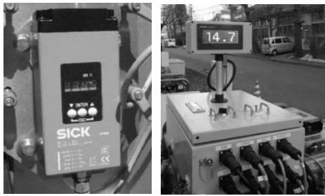
【写-1:左 測長センサ 右 距離表示画面】
