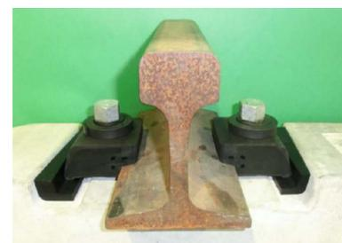
写真-4 試作したゴム製締結装置
