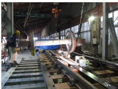
写真1 軌きょう衝撃荷重試験概要
