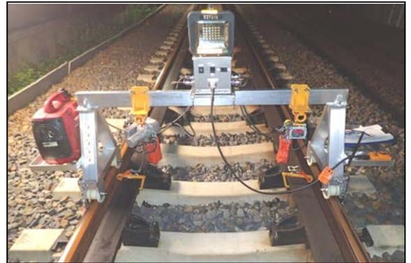
図-4 脱線防止ガード転換器
