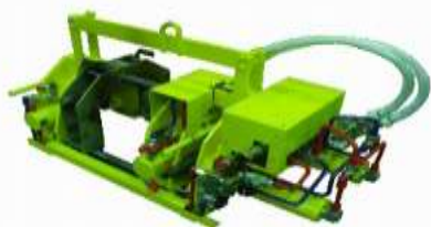
図-1 開発した緊張ガス圧接機
