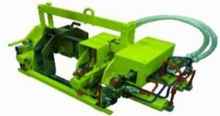
図-1 開発したレールガス圧接機 (TGP-8)
