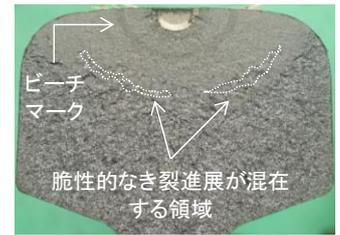
図 2 破断面例
