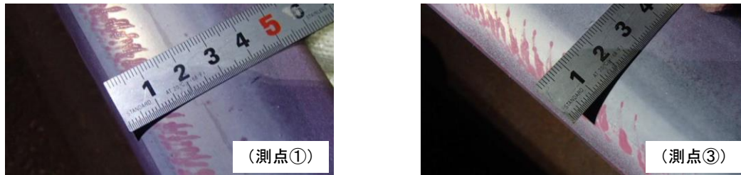
図5. キシミ割れ発生状況
