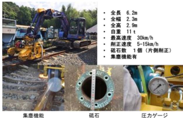
写真-1 軌陸式レール削正機
