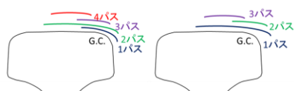
図-1 削正パターン（左 4 パス、右 3 パス）
