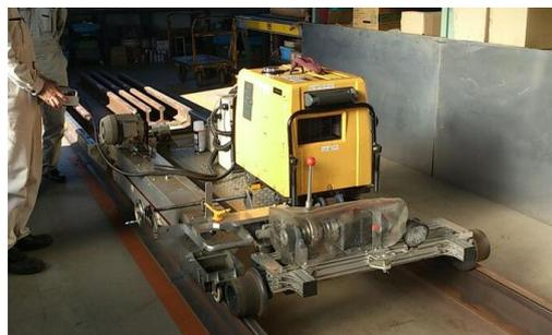
写真-1 ベルト式削正器
