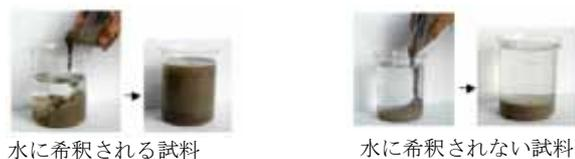
室内試験の結果、ブリーディング試験ではエアモルタル、ノンブリーディング充填材ではブリーディングは見られなかったがセメントベントナイトは13%となった。水中打設試験では、エアモルタルは希釈され、消泡分と希釈水分とセメントと砂に分かれた。セメントベントナイトは、希釈懸濁水とセメントベントナイトの2層に分かれ希釈された部分は固結しなかった。ノンブリーディング充填材は希釈されず水と2層に分かれ固結した。
