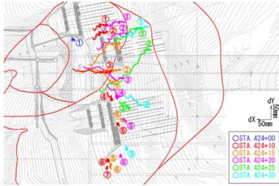
図-3 トンネル到達時地表面変位量
