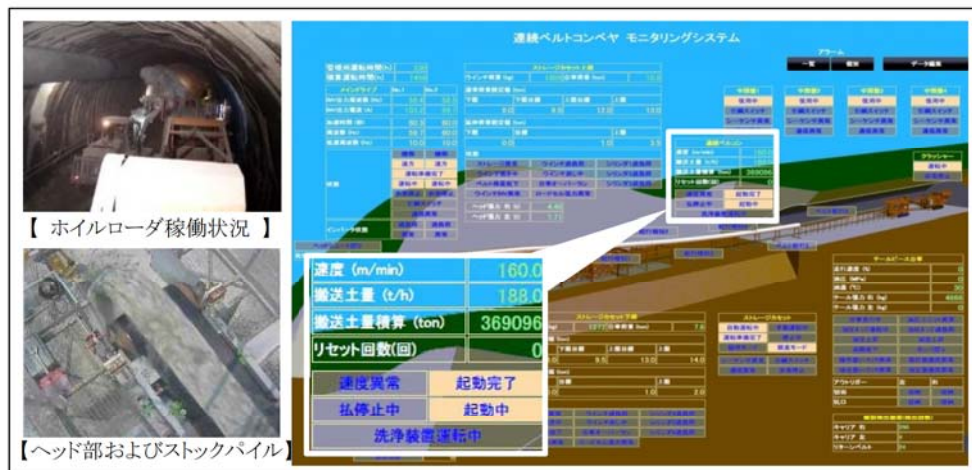
図-6. 連続コンベヤモニタリングシステム表示画面および監視カメラ画像
