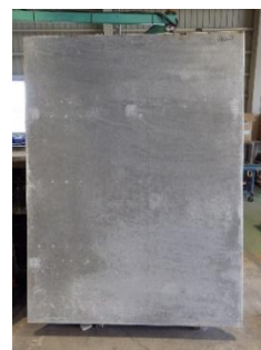
写真-5 パネル試験製作の結果 (ひび割れなし)
