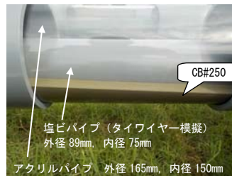
写真-10 注入状況
