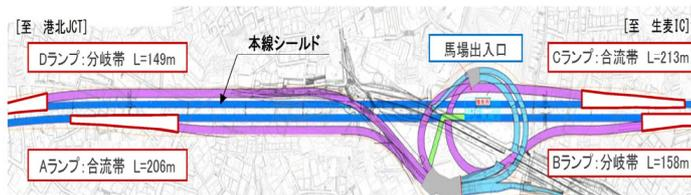
図-1 地中拡幅工事位置図
