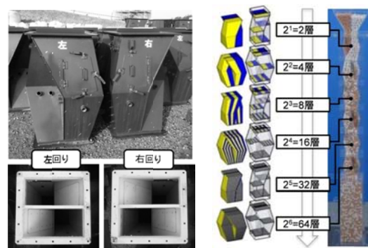
写真-2 混合ユニット
