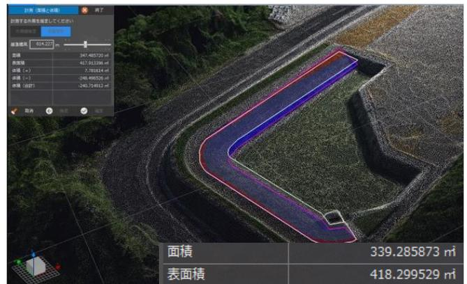
図-4 法面積の測定結果
