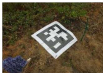
写真.3 UAV基準点
