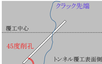
図-3 斜め注入削孔
