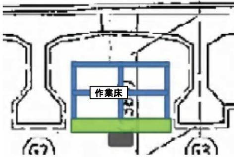
図.1 主桁間での作業イメージ
