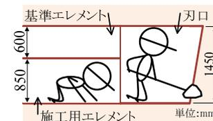
図-3 ダブルエレメント側面模式図
