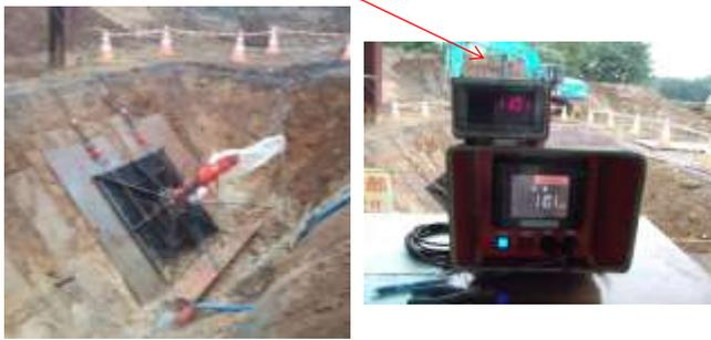
写真-1 引抜試験状況
