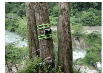
写真-8 増設した土砂崩壊検知装置
