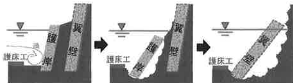
図 - 6 翼壁流出のメカニズム
