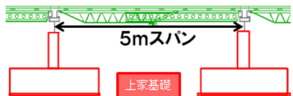
図-4 仮設ホーム側面図(ペコビーム)
